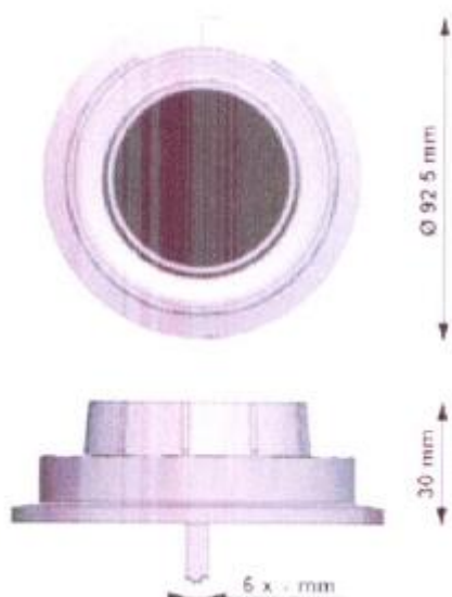
Fig. 3: Medidas do disco indicador e anel
