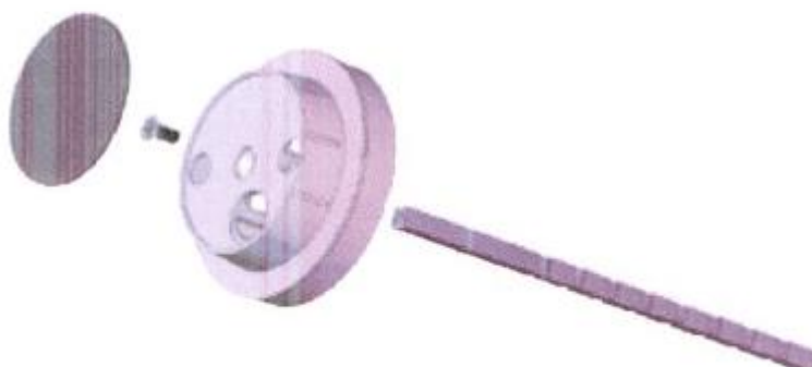
Fig. 4: Conexão do disco indicador e anel / eixo quadrado
